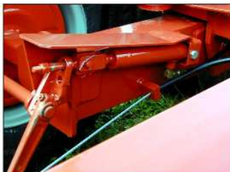
geschützt angebrachter Bremszylinder mit Freigang für Handbremse
