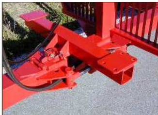
Krankonsole, Deichsel Sperre mit Fernbedienung
