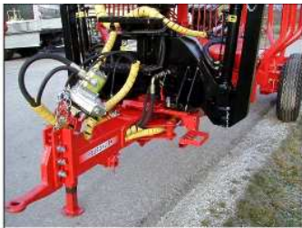
Eigene Ölversorgung mit Aufsteckpumpe
