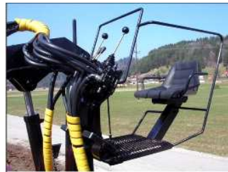
Hochstand mit 2-Hand- und Pedalsteuerung
