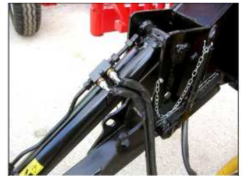
Flügelstützfuß mit automatischen Sperrventil
